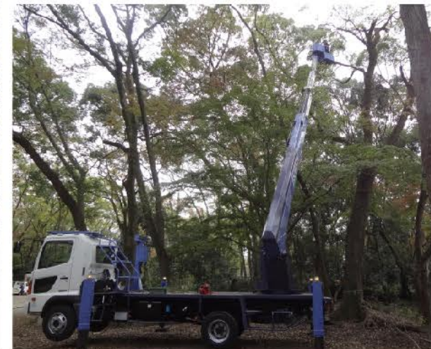
最大地上高25メートルの高所作業車による危険枝の撤去作業（高所からの確認により、腐植している危険枝の剪定作業も実施できました）
